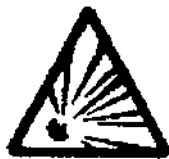
RIESGO DE EXPLOSION MATERIAL EXPLOSIVO
