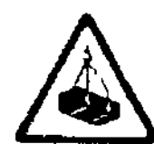
RIESGO DE CARGAS SUSPENSAS
